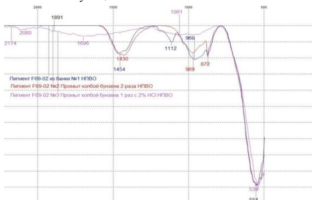
Рис. 2. ИК-спектр пигмента без промывки, промытого дистиллированной водой, а также 2%-ным соляным раствором
